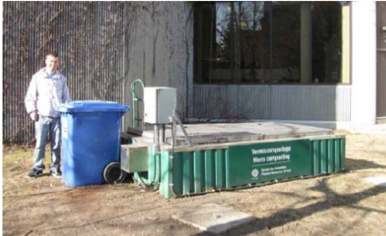
Figure 113: Installation extérieure de vermicompostage de l'Université d'Ottawa qui permet de composter environ 4 tonnes de matières végétales annuellement (photo Université d'Ottawa).
