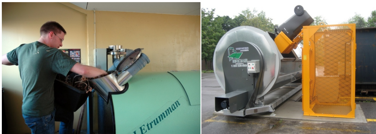
Figure 55: (a) Chargement manuel pour un composteur communautaire. (b) Levée mécanique pour charger un composteur institutionnel (photos Louise Hénault-Ethier).
