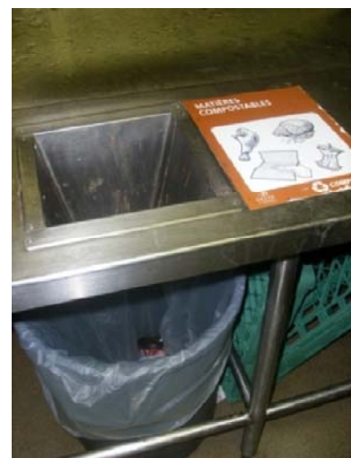
Figure 9: (a) Signalisation en Lexan avec rétro-impression qui résiste au lavage (b) Vinyle imprimé sur le recto usé par le frottement.
