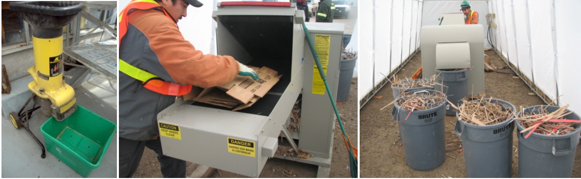
Figure 38: Déchiqueteur pour résidus de jardin (photo Louise Hénault-Ethier). (b et c) Déchiqueteur industriel pour le carton (photo Paul Larouche).
