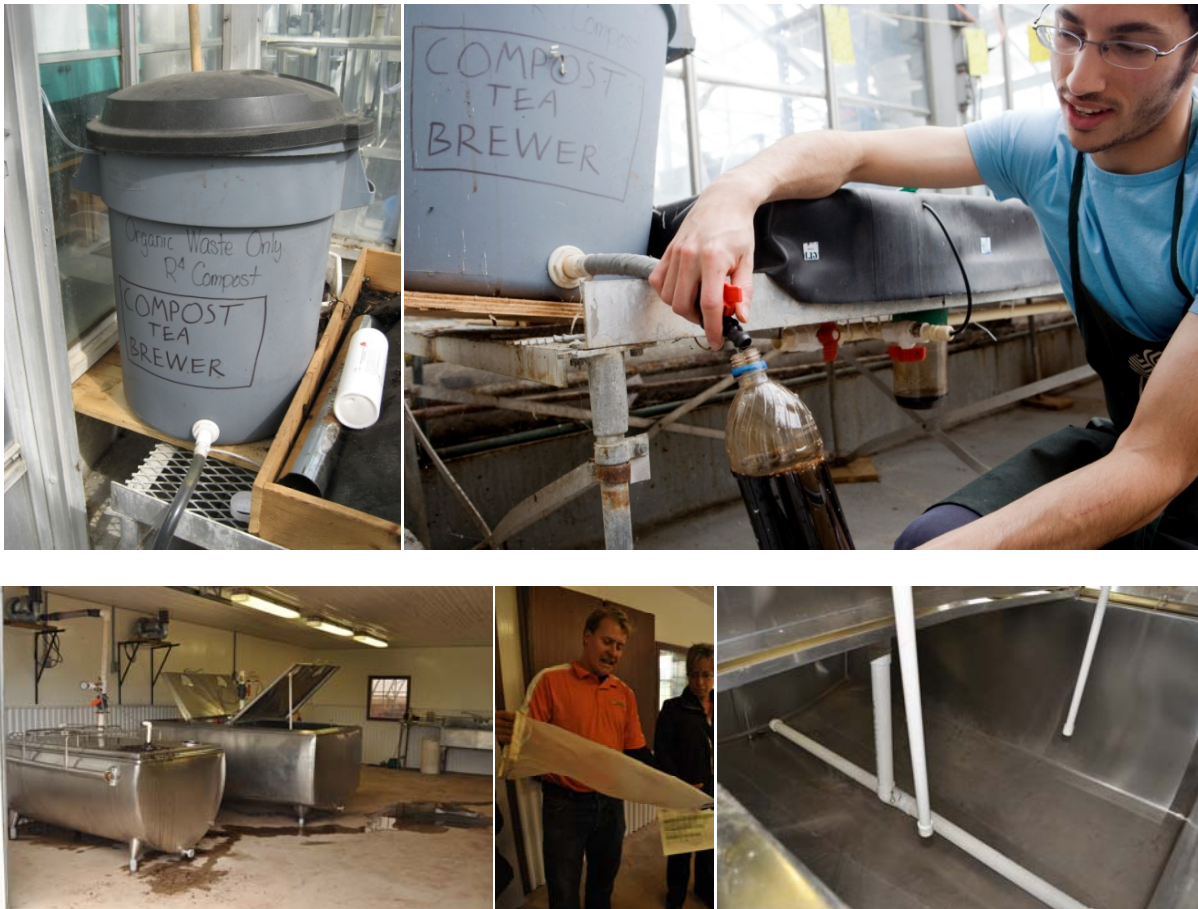
Figure 35: Appareil simple pour fabriquer du thé de compost. Le compost mature placé dans une pochette de géotextile est immergé quelques jours dans (a) un contenant d'eau où on injecte de l'air (photo Louise Hénault-Ethier). (b) Le thé est ensuite récolté par un drain au bas du contenant (photo Creative Media Services/Concordia University). (c) Des systèmes plus grands et performants existent aussi. (d) On contient le compost dans un filet et (e) on injecte de l'air dans le réservoir. (photos Louise Hénault-Ethier).
