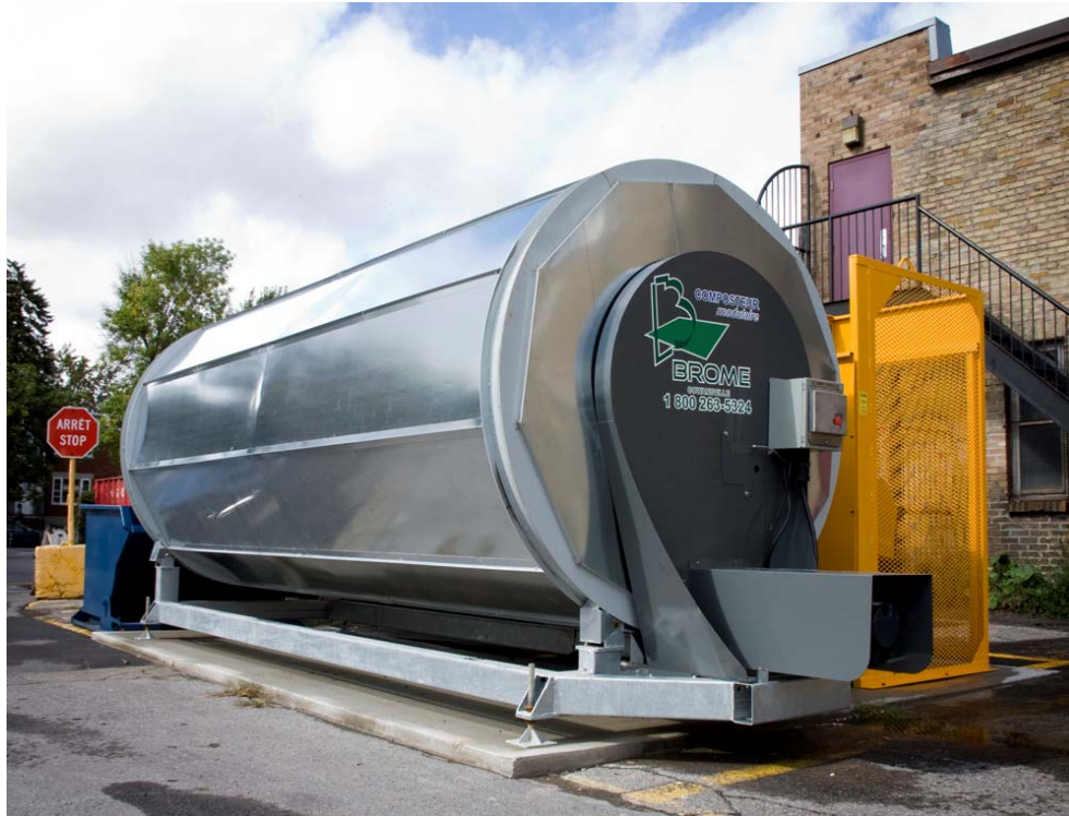
Figure 95: Composteur industriel fonctionnant en continu, sur le campus Loyola de l'université Concordia (photo Louise Hénault-Ethier).
