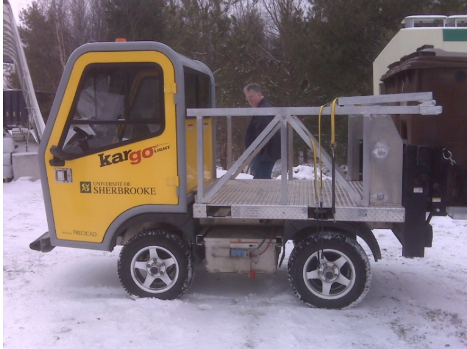
Figure 105: Camion électrique pour acheminer les résidus organiques vers le composteur (photo Alexis Fortin).
