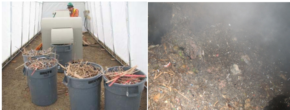
Figure 137: (a) Les résidus de cartons sont déchiquetés et servent de matière carbonée dans le composteur. (b) À l'intérieur du composteur, le compost a une consistance homogène, une humidité idéale et chauffe bien (photos Paul Larouche).
